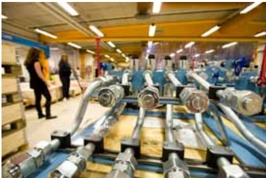
Hydraulaggregaten som tillverkas på Specma Hydraulic används bland annat inom marin industri, vid gruvsdrift och pappersbruk.
