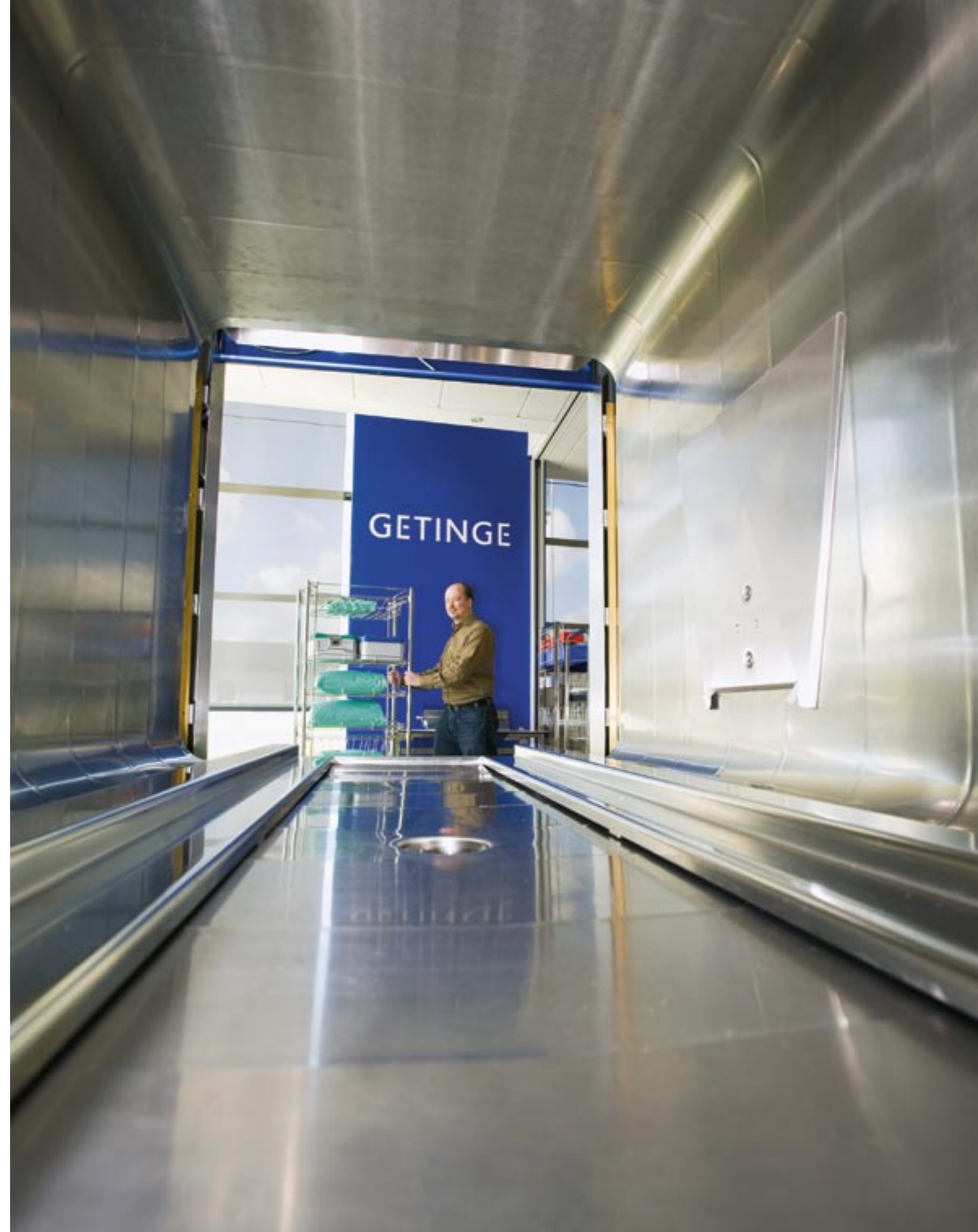
Mellan ren zon och steril zon forslas operationsinstrumenten genom Getinges autoklaver, där de steriliseras. Processen tar ungefär 40 minuter och sker i 134-gradig ånga. Målet är att få ett jämt flöde och undvika flaskhalsar. Niclas Gerdin, en av medlemmarna i designteamet, övervakar.
