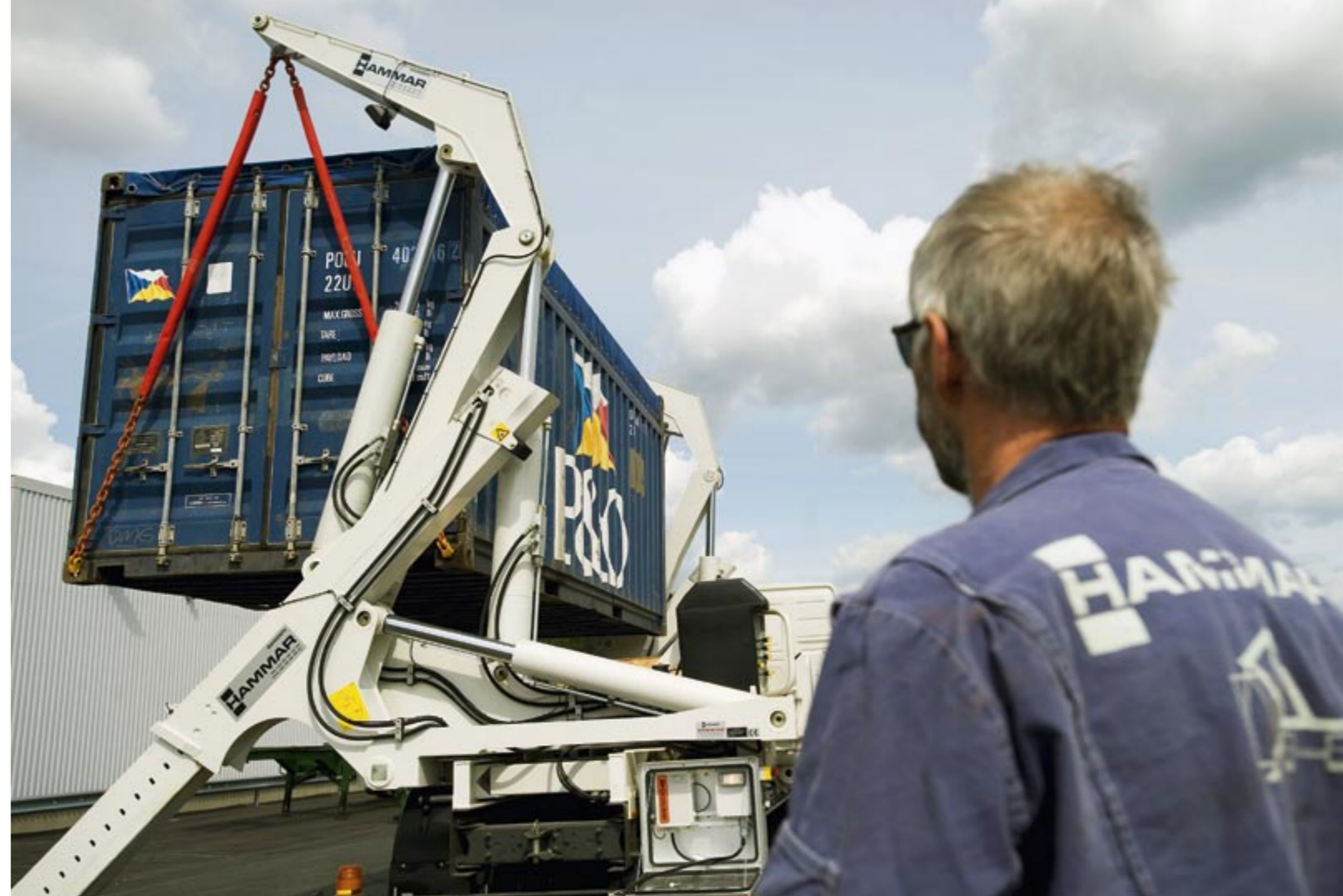
Alla sidlastare som tillverkas på Hammar Maskin är orderbeställda och skräddarsys efter kundernas önskemål. Innan leverans provlyfter alltid Hammar Maskin en container och gör en slutbesiktning för att säkra den höga kvaliteten. Bild: STEFAN IDEBERG
