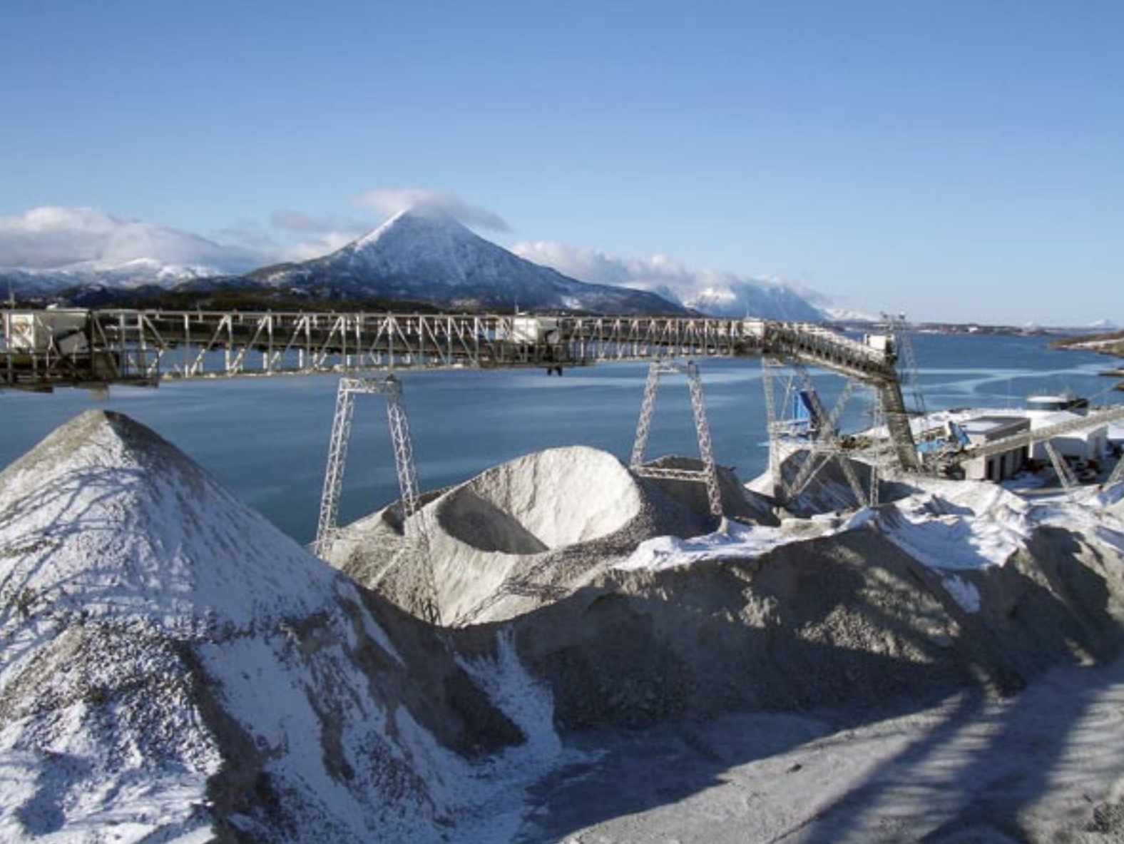
Allt som hanteras i stora mängder i lösvikt är en uppgift för Kellve Bulkteknik. På bilden en Kvänumproducerad bandtransportör vid Hustamarmors kalkbrott i Fræna, Norge.
