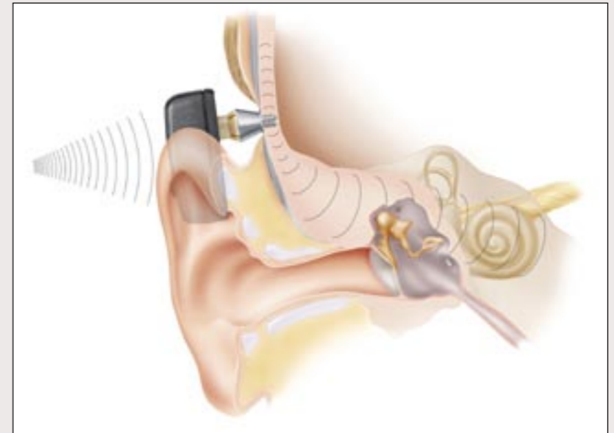
Baha-apparaten fungerar med hjälp av ett litet implantat i benet strax bakom örat – en lösning som avsevärt förbättrar ljudkvaliteten för bäraren. © Cochlear Bone Anchored Solutions AB
